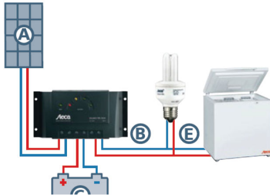
Fig. 3. Ejemplo de aplicación sacado del catalogo de componentes de la empresa Energía y Futuro, fabricante Steca. Este ejemplo sería válido si únicamente alimentáramos receptores en c.c., en nuestro caso necesitaremos también un convertidor.
